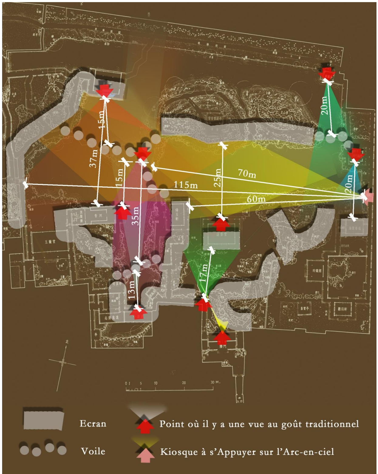
Fig. 239 Analyse des vues du milieu du Zhuzhengyuan (l'ancien jardin du Foyer) : œuvre de l'auteur. Sources dessinées : détail de la fig. 95 « Plan du milieu et de l'ouest ».
