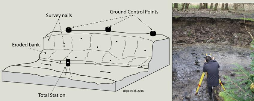
Mise en place d'un réseau de benchmarks fixes pour la création d'un système planimétrique local. A chaque nouvelle campagne de mesures, des clous d'arpentage sont implantés dans la berge et relevés à la Station Totale. Ils serviront de points de contrôle (GCP) pour le géoréférencement des nuages de points 3D.
