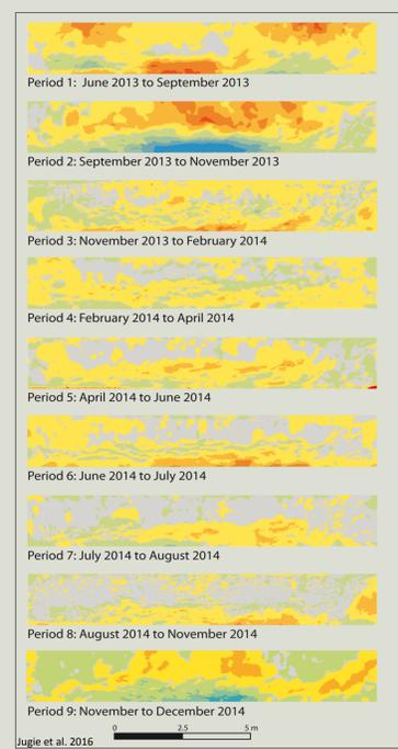
L'algorithme M3C2 est précis (<1cm) et permet de travailler directement avec les données brutes en sortie du logiciel VisualSFM. Il est robuste aux données manquantes et aux erreurs de mesure. Ajoutée à un suivi du fonctionnement hydrologique de la rivière, ces données permettent de mieux comprendre les mécanismes et processus responsables de l'érosion de la berge.
