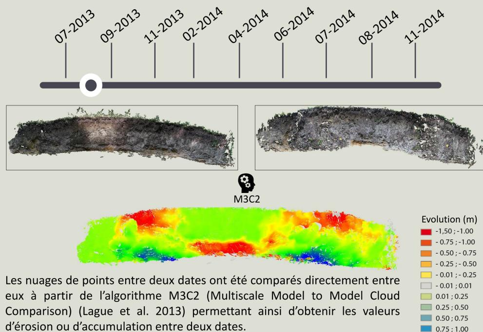
Les nuages de points entre deux dates ont été comparés directement entre eux à partir de l'algorithme M3C2 (Multiscale Model to Model Cloud Comparison) (Lague et al. 2013) permettant ainsi d'obtenir les valeurs d'érosion ou d'accumulation entre deux dates.
