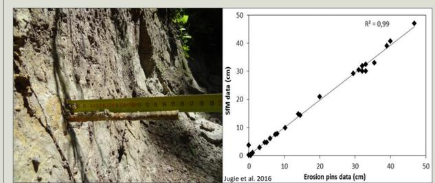
La validation de l'ensemble de la méthode photogrammétrique a été effectuée par des mesures indépendantes de l'érosion le long de barres de fer implantées dans la berge.
