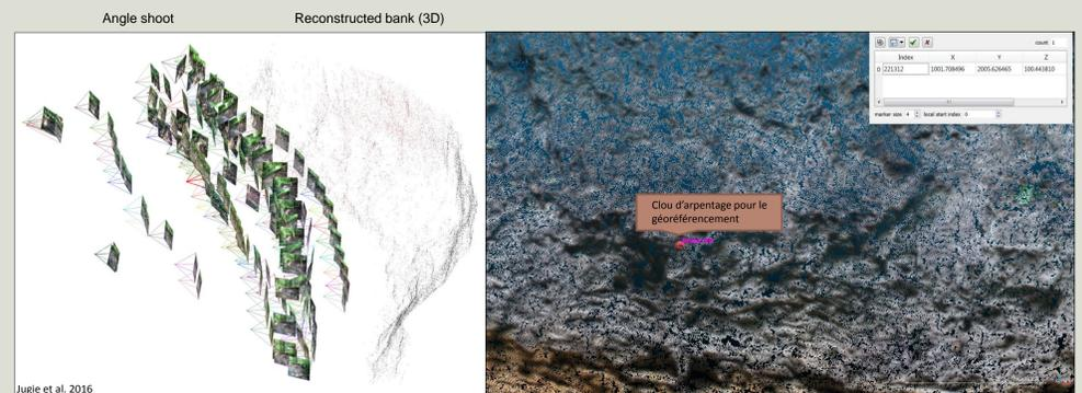
Le nuage de points 3D est créé à partir du logiciel libre VisualSFM en s'appuyant sur les algorithmes CMVS (Clustering View for Multiview Stereo) et PMVS (Patch-based Multiview Stereo).
